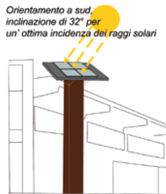
Pannelli solare termico (acqua calda sanitaria)
